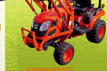
Gage de qualité, il possède des béquilles intégrées au brancard assurant un attelage-dételage rapide par de simples axes.
