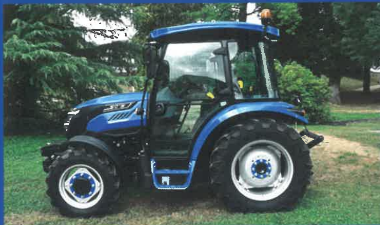
4 roues motrices, inverseur de marche synchronisé et boîte de vitesse 12+12
