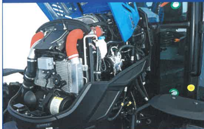
Moteur 3065cm3 CRDI stage V. Propre et silencieux répondant aux dernières normes.
